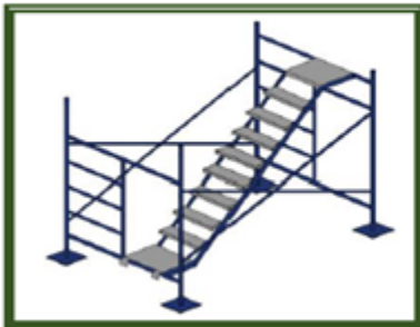
Andamio con Escalera
